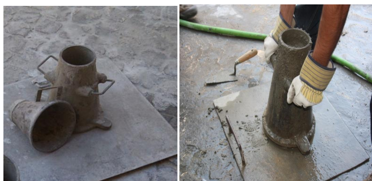
Figura 3.20 - Material para execução do ensaio de abaixamento (esquerda) . Execução do ensaio (direita).
