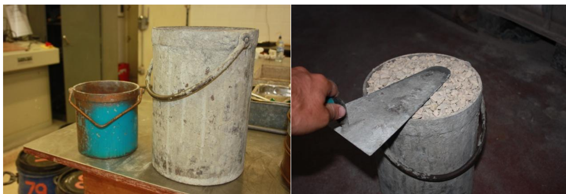
Figura 3.7 - Recipientes para medição da baridade (esquerda). enchimento do recipiente com Brita 1 (direita).
