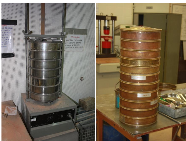
Figura 3.2 - Peneiros na máquina de vibração (esquerda) . Coluna de peneiros normalizados (direita).
