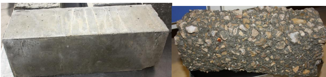
Figura 4.21 - Betão B20R - No início (esquerda) e ao fim de 300 ciclos de gelo-degelo (direita).
