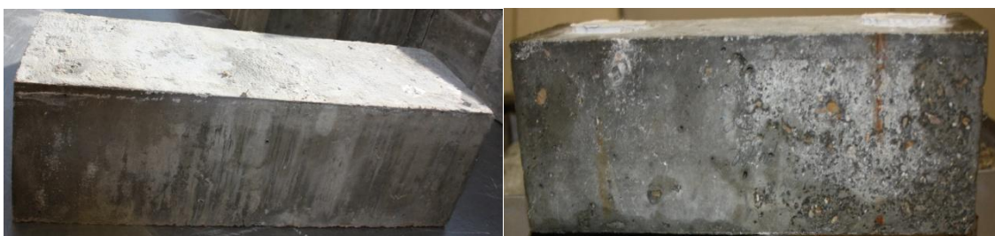
Figura 4.25 - Betão HB20R - No início (esquerda) e ao fim de 300 ciclos de gelo-degelo (direita).
