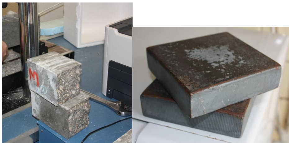
Figura 3.24 - Esquerda: metades resultantes do ensaio à flexão dos provetes prismáticos, prontas a serem ensaiadas à compressão. Direita: pratos auxiliares para ensaio à compressão de cubos de 100mm de aresta e partes resultantes dos provetes prismáticos.
