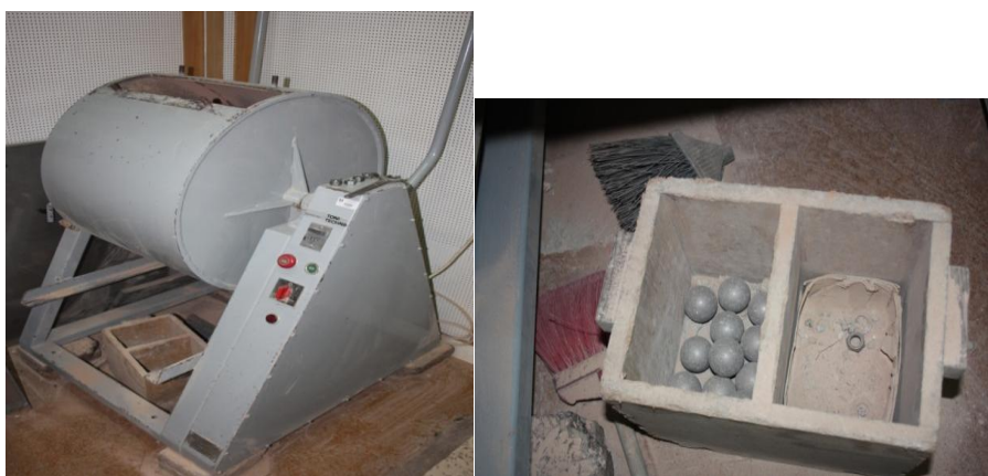
Figura 3.8 - Máquina para realização do ensaio (esquerda). Esferas metálicas (direita).
