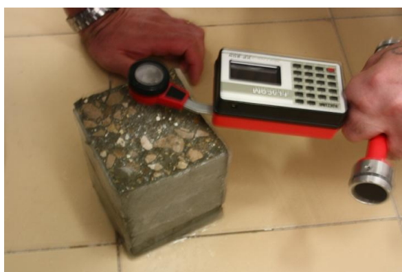
Figura 3.33 - Inspeção visual com recurso a lupa para detecção de cristais de gelo.
