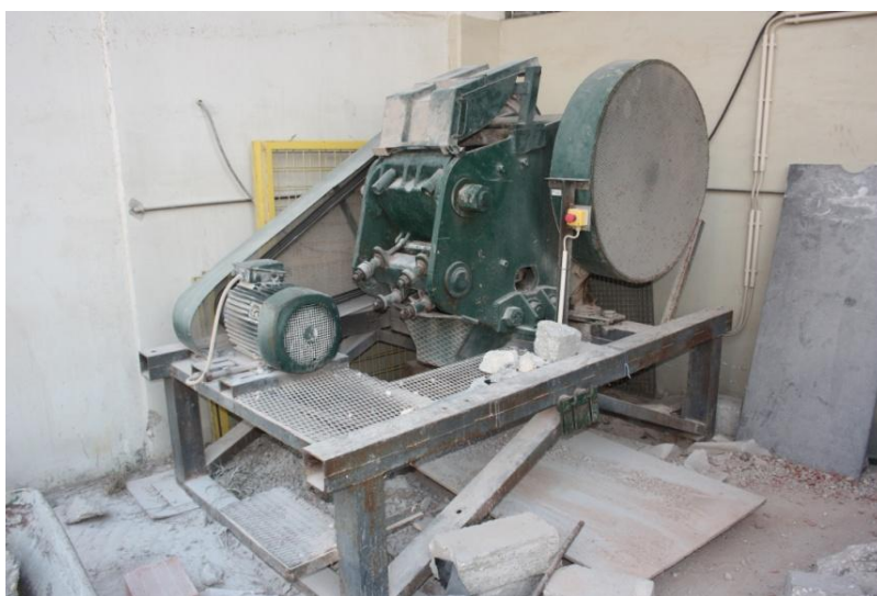
Figura 3.14 - Britadeira utilizada para a reciclagem de betão.
