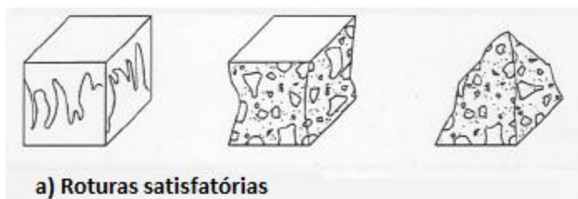
Figura 3.25 - Roturas satisfatórias segundo a NP EN 12390-3 (2003).
