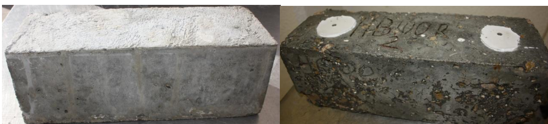
Figura 4.27 - Betão HB100R - No início (esquerda) e ao fim de 300 ciclos de gelo-degelo (direita).
