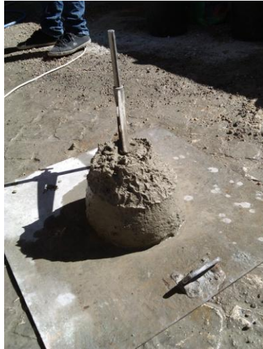
Figura 3.22 - Medição do abaixamento (esquerda). Medição do abaixamento segundo a NP EN 12350-2 (2002) (direita).
