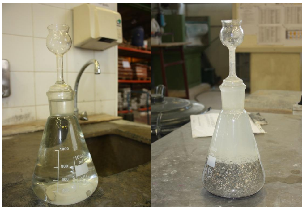
Figura 3.6 - Esquerda: obtenção da massa M_3 . Direita: obtenção da massa M_2 .
