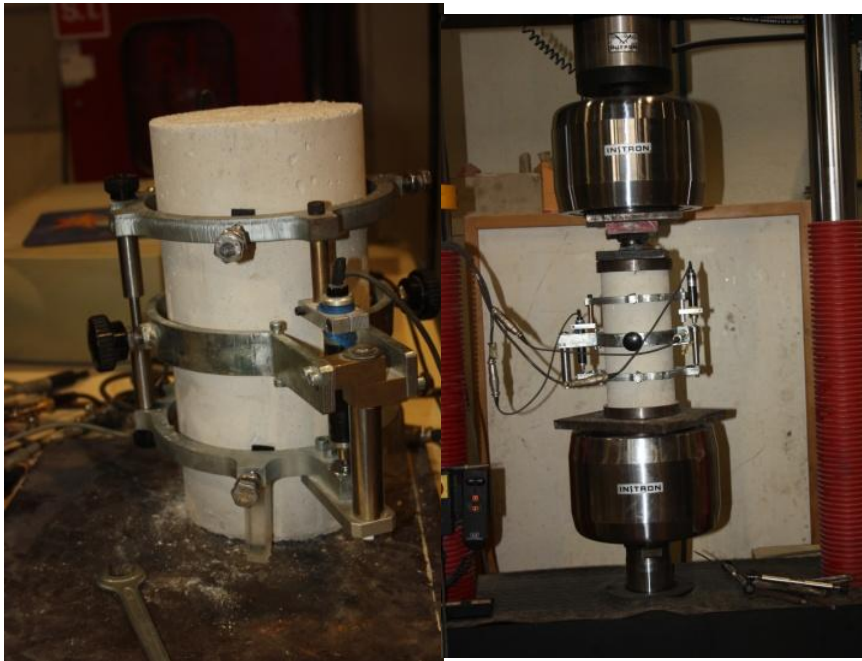
Figura 3.29 - Gaiola metálica acoplada ao provete para medição das deformações. Equipamento de ensaio para determinação do módulo de elasticidade (direita).
