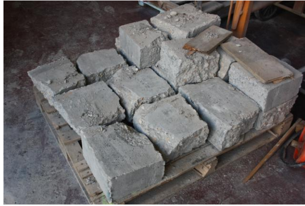
Figura 3.13 - Blocos de betão prontos para reciclagem.
