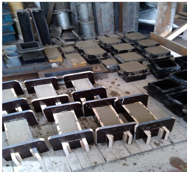
Figura 3.18 - Moldes correspondentes a uma betonagem preenchidos.
