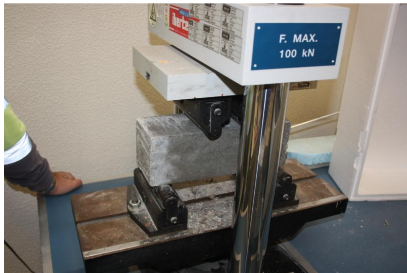
Figura 3.28 - Ensaio de resistência à tração por flexão.
