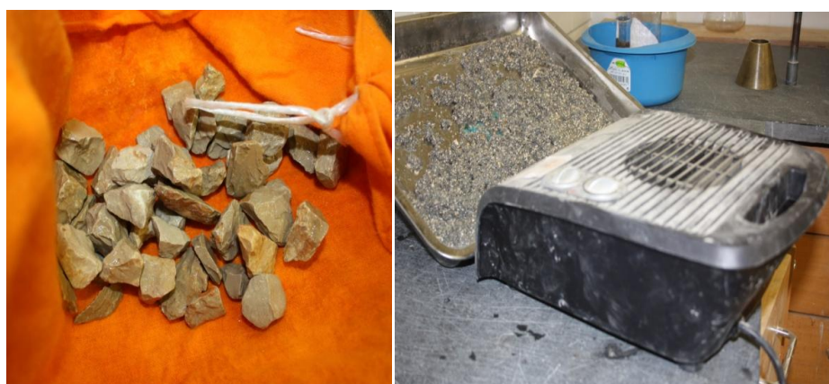
Figura 3.4 - Secagem da superfície de agregados grossos (esquerda). Secagem da superfície de agregados finos (direita).
