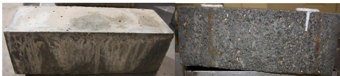
Figura 4.29 - Betão HB20RIA - No início (esquerda) e ao fim de 300 ciclos de gelo-degelo (direita).
