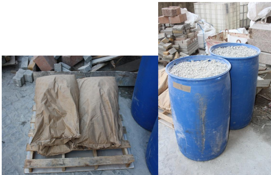
3.1 - Sacos com areia calibrada (esquerda). Agregados reciclados, obtidos através da britagem de betão (direita).
