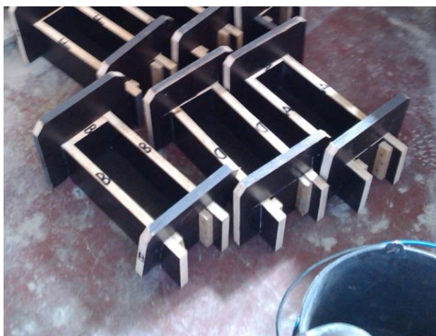
Figura 3.15 - Moldes em contraplacado marítimo para execução de provetes prismático 100 x 100 x 300 mm.
