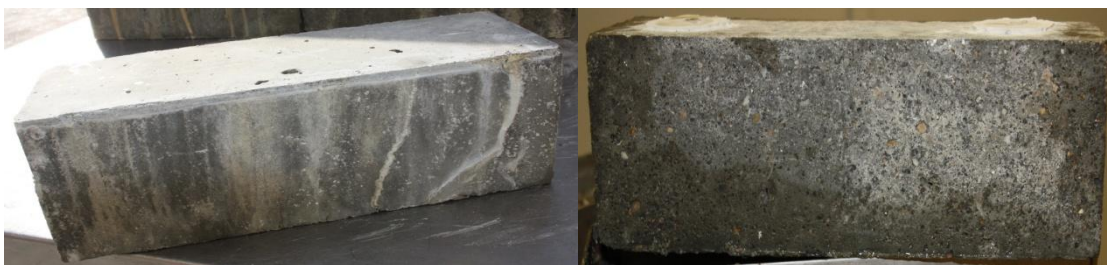
Figura 4.28 - Betão HBRIA - No início (esquerda) e ao fim de 300 ciclos de gelo-degelo (direita).
