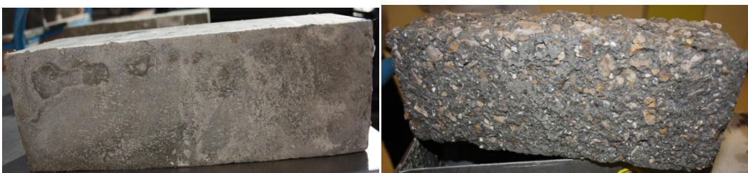
Figura 4.22 - Betão B50R - No início (esquerda) e ao fim de 300 ciclos de gelo-degelo (direita).
