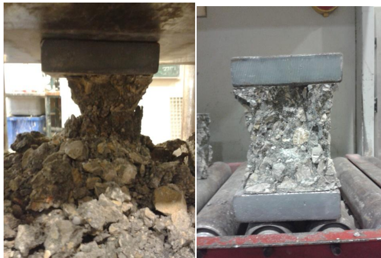
Figura 4.47 - Ensaio de resistência à compressão de um provete do tipo B50R após 300 ciclos de gelo-degelo (esquerda). Ensaio de resistência à compressão de um provete do tipo HBR após 300 ciclos de gelo-degelo (direita).
