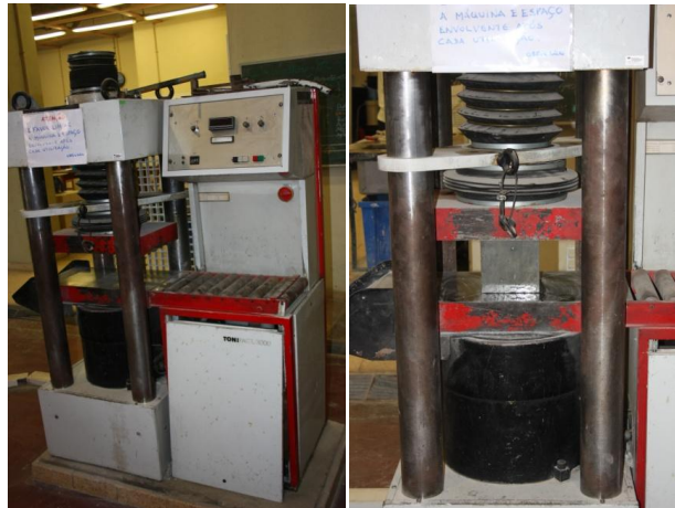
Figura 3.23 - Máquina para ensaio à compressão (esquerda). Ensaio à compressão de um cubo de aresta igual a 150 mm (direita).
