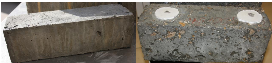
Figura 4.31 - Betão HBRIA - No início (esquerda) e ao fim de 300 ciclos de gelo-degelo (direita).
