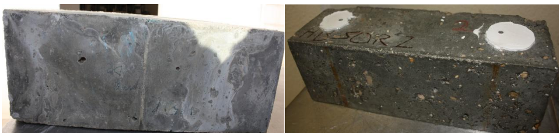
Figura 4.26 - Betão HB50R - No início (esquerda) e ao fim de 300 ciclos de gelo-degelo (direita).
