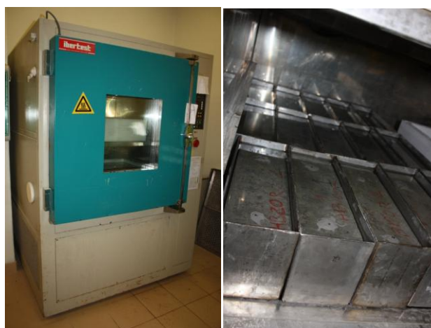
Figura 3.36 - Câmara gelo-degelo (esquerda). Provetes colocados dentro das caixas metálicas no interior da câmara (direita).
