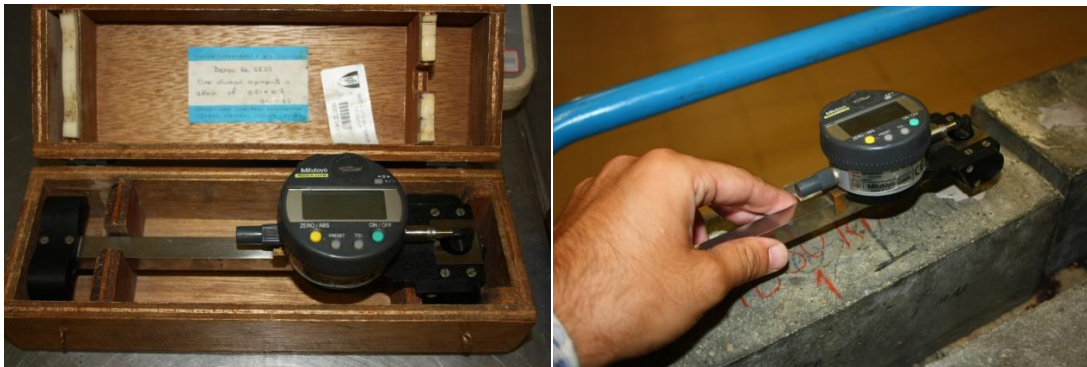
Figura 3.32 - Esquerda: comparador. Direita: medição da variação de comprimento ao fim de n ciclos.
