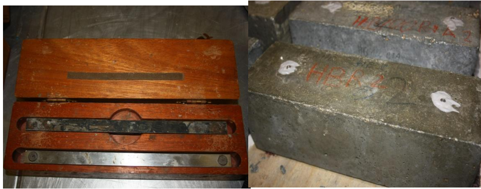
Figura 3.31 - Régua de calibração do comparador (esquerda). "Pastilhas" coladas nos provetes prismáticos para medição da variação de comprimento ao longo do tempo (direita).
