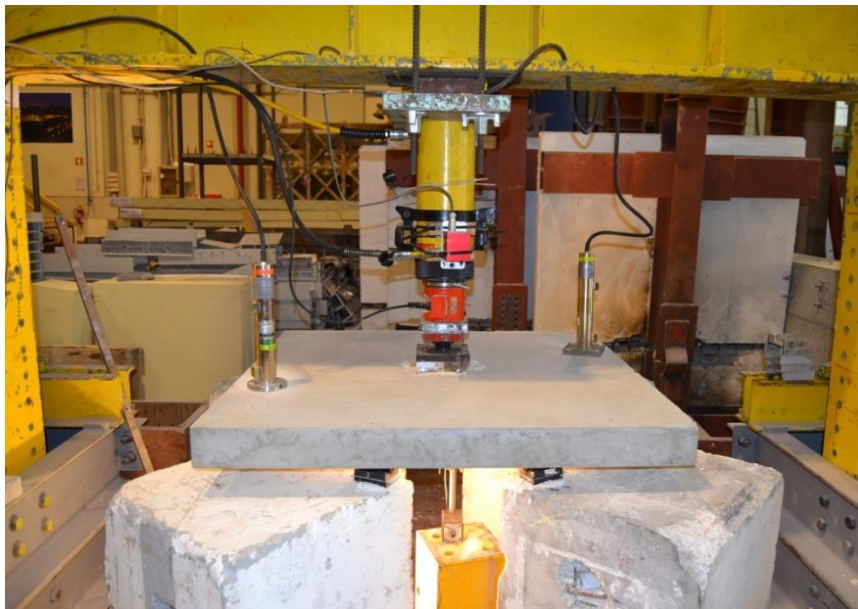
Figura 3.10 - Sistema de ensaio das lajes da campanha experimental
