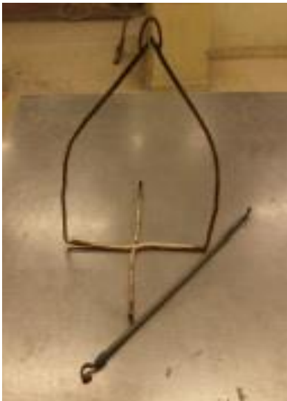
Figura 3.4 - Estrutura metálica de suporte e cabo de suspensão
