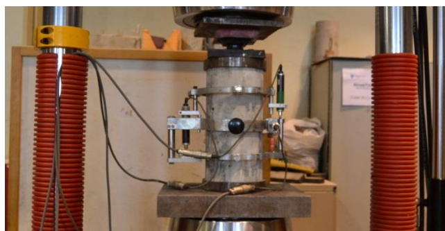
Figura 3.8 - Provete e instrumentação na prensa hidráulica
