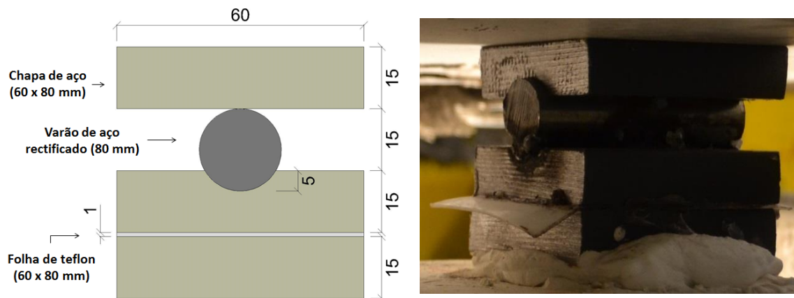
Figura 3.11 - Esquema do sistema de ensaios da campanha experimental
