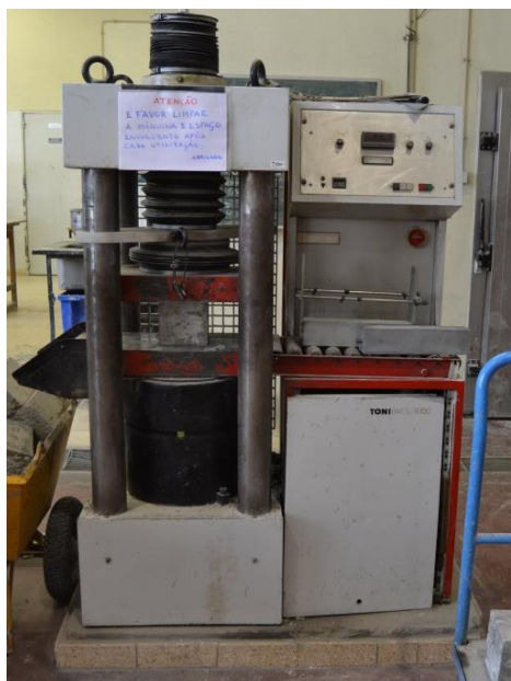
Figura 3.6 - Ensaio de compressão a um provete cúbico na prensa hidráulica
