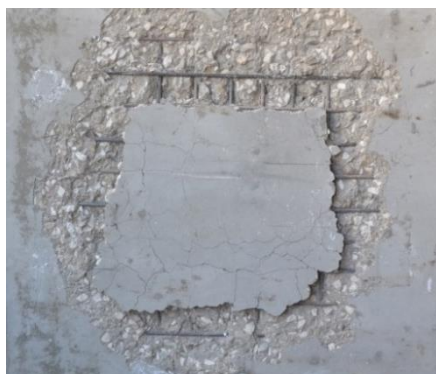
Figura 4.10 - Face inferior do modelo BR-1 após rotura e remoção do recobrimento destacado
