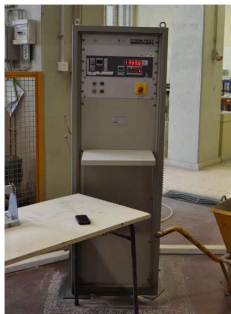
Figura 3.7 - Máquina de controlo da prensa hidráulica durante o ensaio
