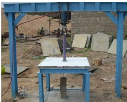
Figura 2.22 - Sistema de ensaios das lajes da campanha experimental de Sudarsana Rao et al. (2012)
