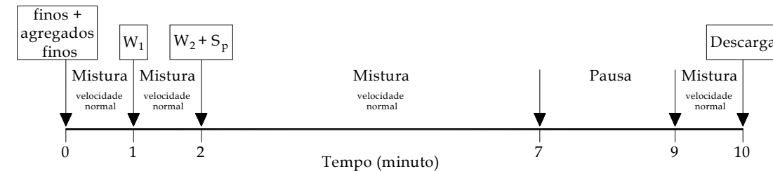
Figura 1: Seqüência de amassadura adoptada para as misturas das argamassas
