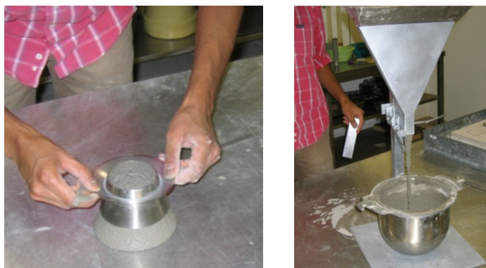
Figura 2: Ensaio de espalhamento (esquerda) e de escoamento (direita) em argamassas
