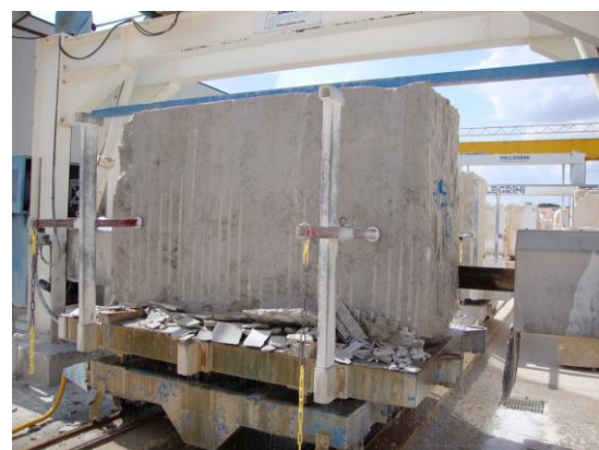
Figura 2.9 - Beneficiamento de bloco de mármore através de utilização de monolâmina
