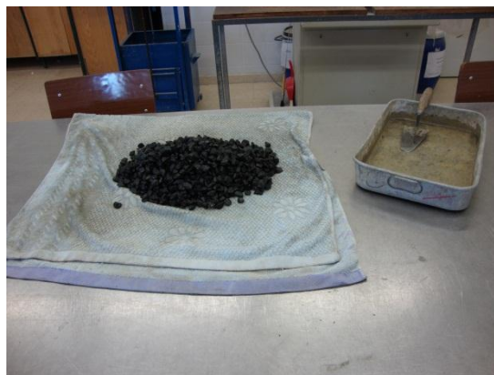
Figura 3.4 - Secagem do agregado com um pano seco
