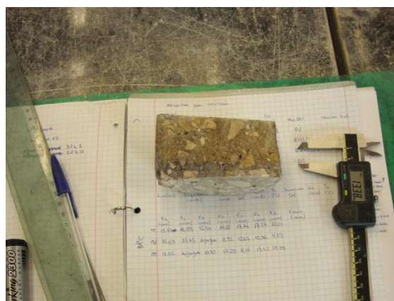
Figura 3.25 - Aplicação de nitrato de prata nas superfícies fracturadas e medição da penetração de cloretos
