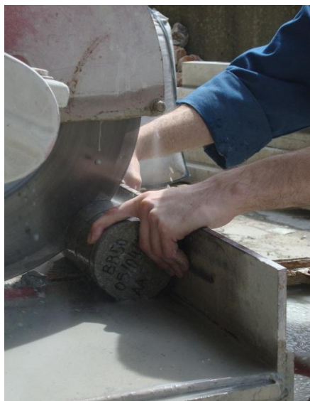
Figura 3.23 - Corte de um provete para o ensaio de resistência à penetração de cloretos
