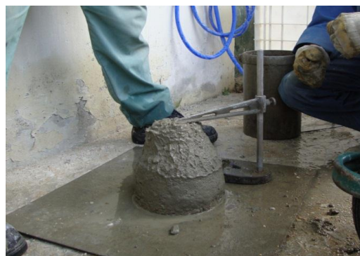
Figura 3.14 - Medição do abaixamento do cone de Abrams
