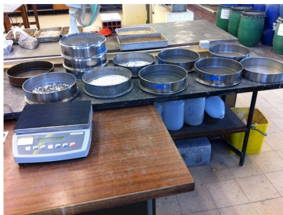
Figura 3.2 - Pesagem do material retido em cada peneiro
