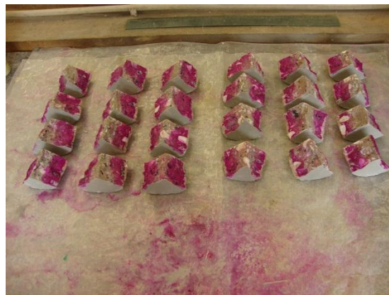
Figura 3.21 - Aplicação da solução alcoólica de fenolftaleína a 0,1% nas superfícies fracturadas
