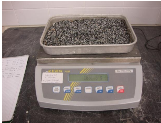
Figura 3.6 - Pesagem da amostra depois de evaporada a humidade superficial
