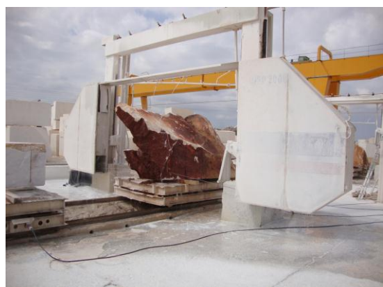
Figura 2.8 - Beneficiamento de blocos de mármore através da utilização de monofio
