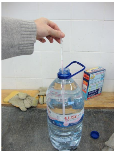
Figura 3.3 - Medição da temperatura da água do recipiente utilizado como picnómetro vazio
