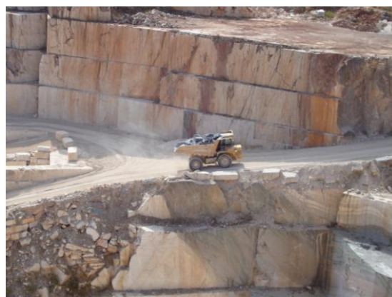
Figura 2.7 - Transporte, por intermédio de dumper , de inertes para as escombreliras
