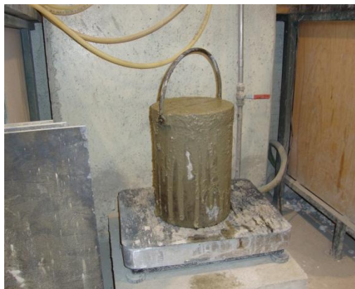
Figura 3.15 - Pesagem do recipiente da massa volúmica com betão
