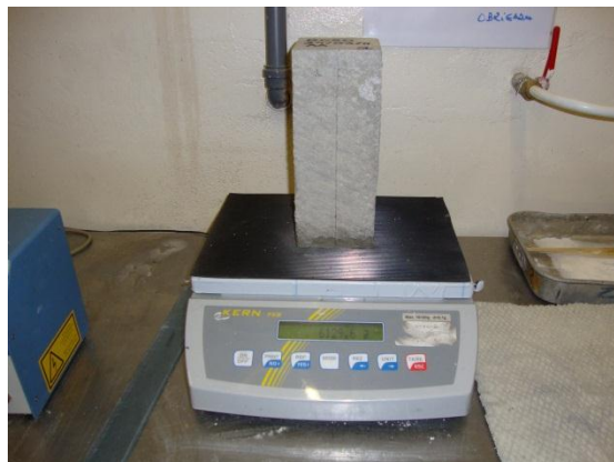
Figura 3.19 - Pesagem de um provete do ensaio de absorção de água por capilaridade
