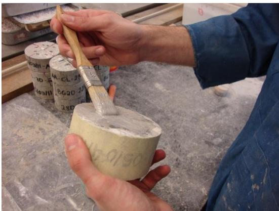
Figura 3.20 - Aplicação de tinta epóxida nos provetes
