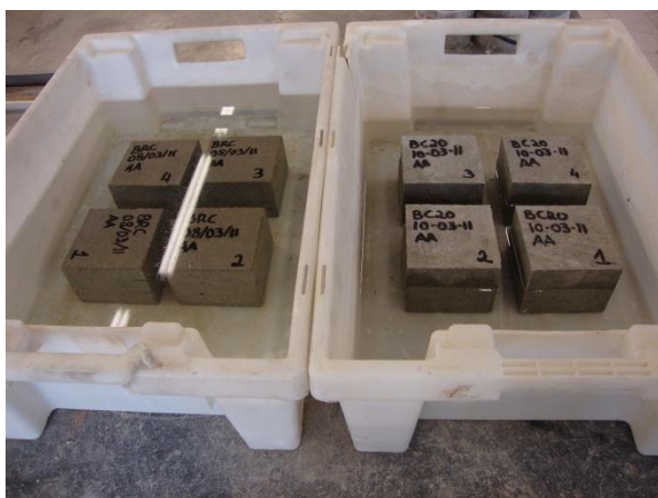
Figura 3.16 - Provete em diferentes fases do ensaio de absorção de água por imersão
