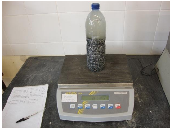
Figura 3.5 - Pesagem do recipiente utilizado como picnómetro contendo a amostra
