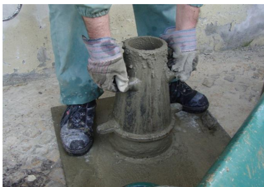
Figura 3.13 - Remoção do molde
