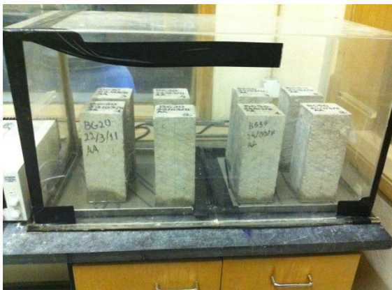
Figura 3.18 - Provete com água até 5 \pm 1 mm de água acima da face inferior
