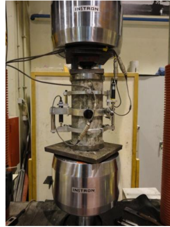
Figura 3.41 - Posicionamento e preparação do provete
