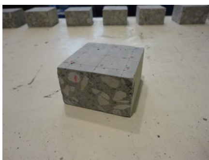
Figura 3.46 - Provetes de ensaio (resistência à abrasão)
