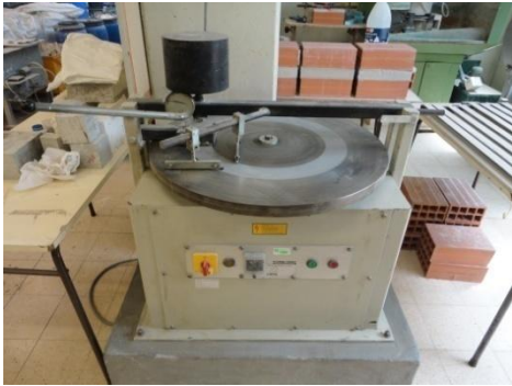
Figura 3.42 - Máquina de abrasão de Böhme
