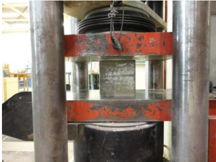
Figura 3.31 - Posicionamento do provete
