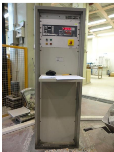
Figura 3.28 - Controlador da prensa hidráulica de 4 colunas
