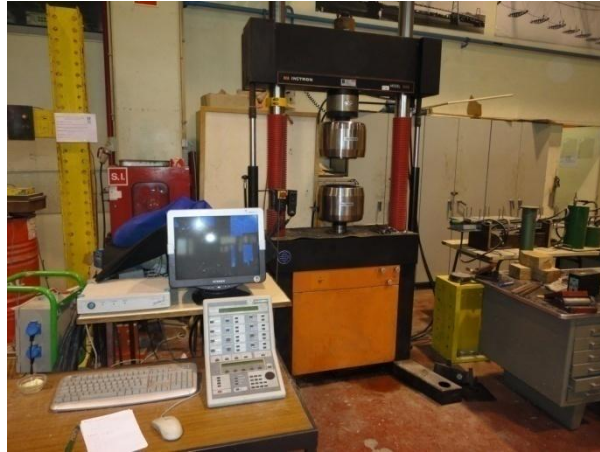
Figura 3.39 - Data logger e prensa hidráulica
