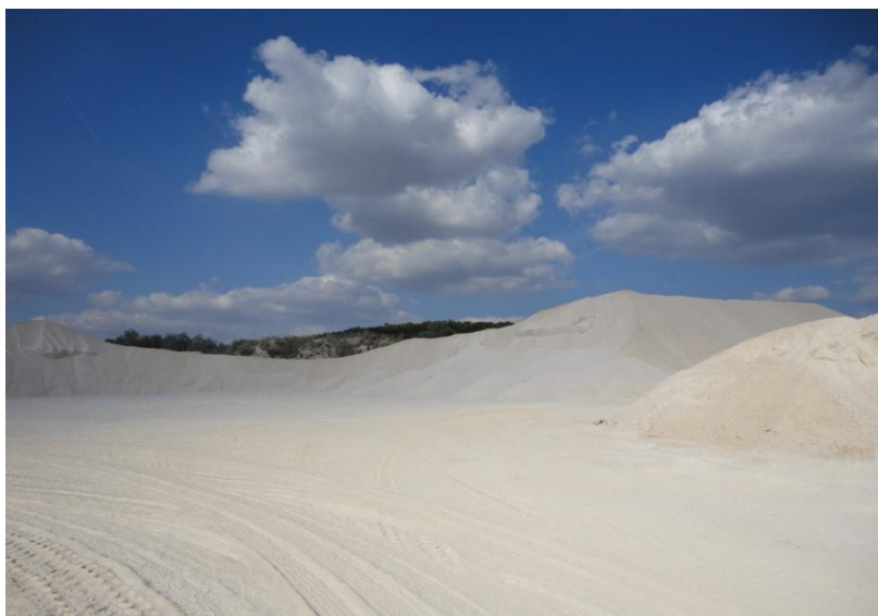
Figura 1.3 - Agregados finos provenientes do processamento dos resíduos da indústria do mármore
