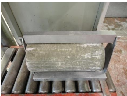
Figura 3.37 - Posicionamento do provete
