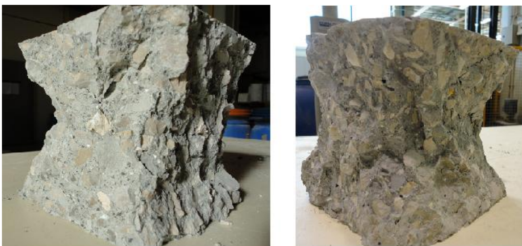
Figura 3.30 - Provetes após ensaio de compressão
