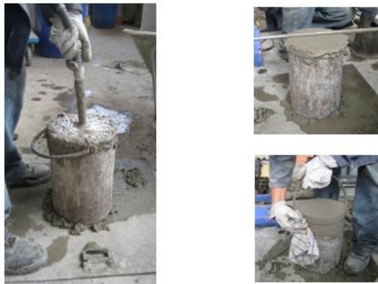
Figura 3.26 - Vibração do provete, alisamento da superfície e limpeza do recipiente
