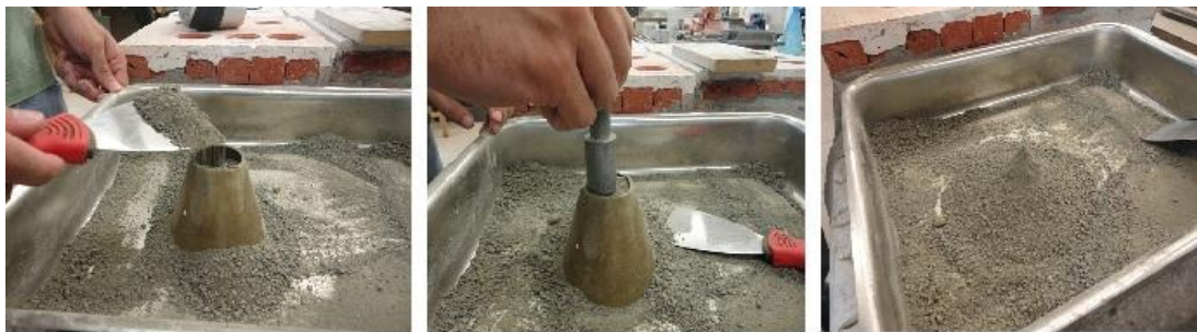
Figura 3.13 - Exemplo do processo de verificação da superfície seca
