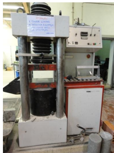
Figura 3.29 - Prensa hidráulica de 4 colunas
