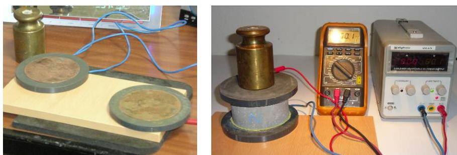
Figura 1. Instrumentação do ensaio de resistividade eléctrica.
