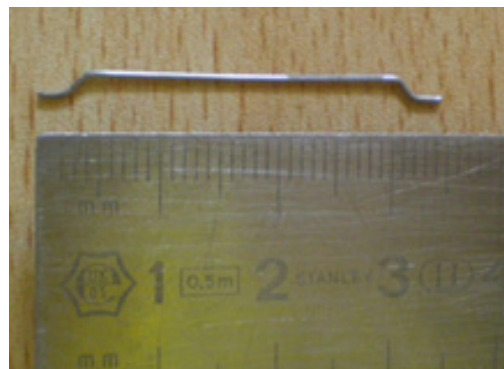
Figura 3: Apresentação das fibras de aço Dramix® RC 65/35 BN utilizada nos modelos.
