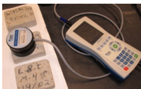
Figura 3 - Medição da condutibilidade térmica em provetes de argamassa com aerogel.
