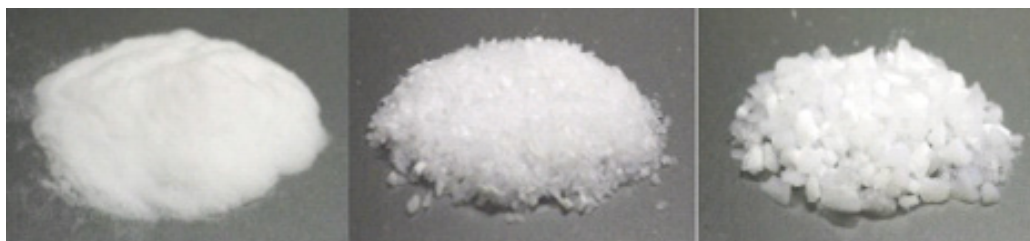
Figura 2 - Aerogel híbrido moído e peneirado, com diferentes granulometrias
