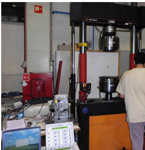
Figura 3.37 - Prensa hidráulica e parte do sistema ( data logger ) acoplado a esta e ao sistema medidor de deformações
