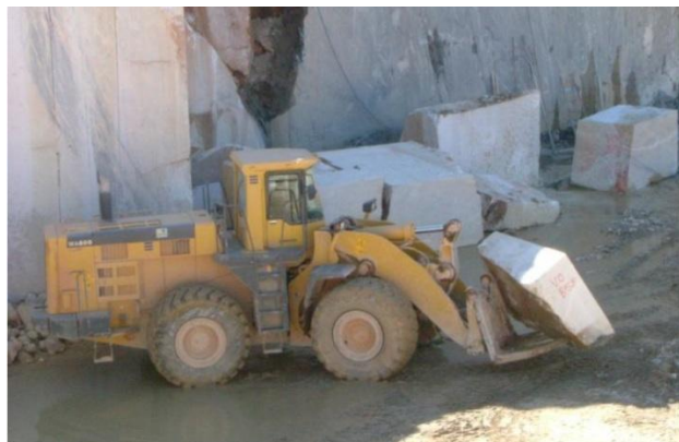
Figura 2.12 - Transporte de blocos
