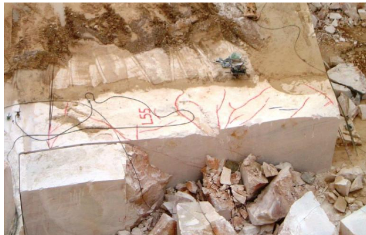
Figura 2.4 - Traçagem de uma massa mineral
