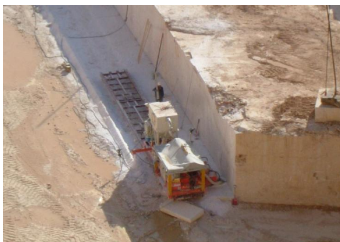
Figura 2.6 - Corte de levante através de roçadora
