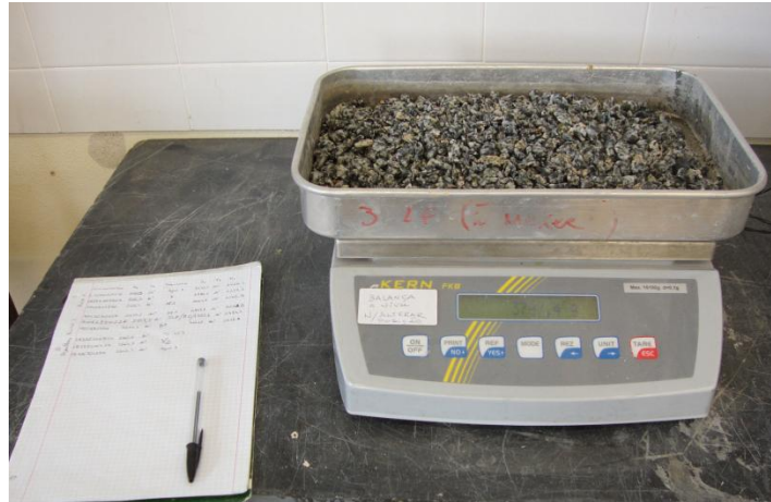
Figura 3.1 - Pesagem de agregado na balança
