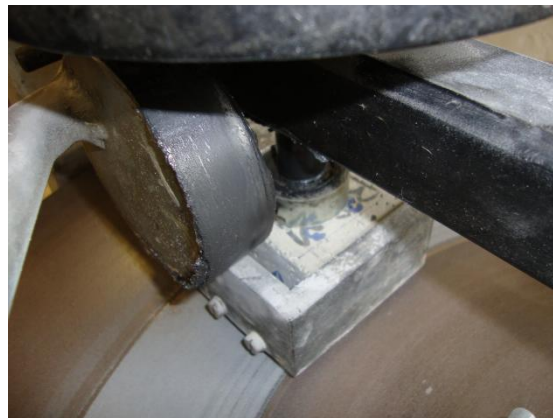
Figura 3.45 - Detalhe do peso a criar carga sobre a face de topo do provete
