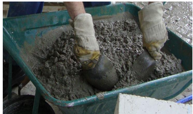
Figura 3.13 - Recolha de amostras, de forma homogénea, com a ajuda de pás
