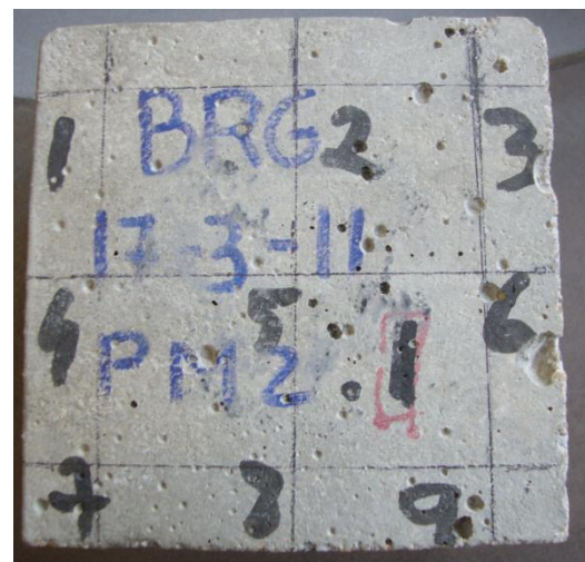
Figura 3.43 - Distribuição dos 9 pontos de medição do desgaste num provete real (betão com agregados grossos de granito (100%))
