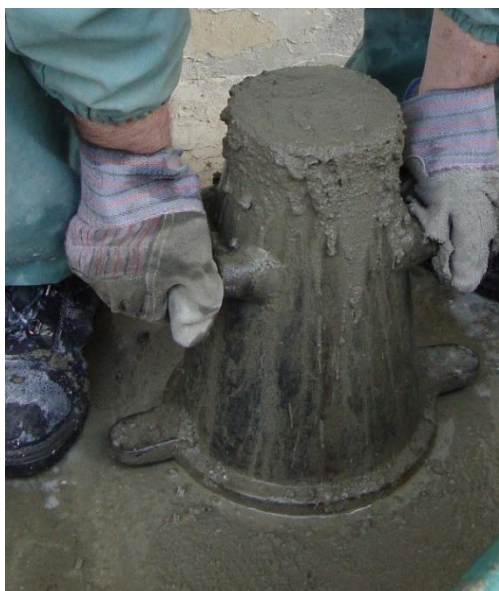
Figura 3.15 - Início da remoção do molde
