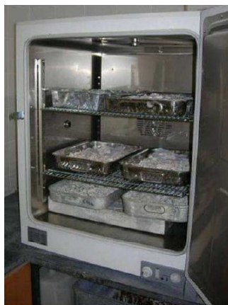
Figura 3.2 - Aspecto da estufa ventilada a uma temperatura de 110 \pm 5 °C
