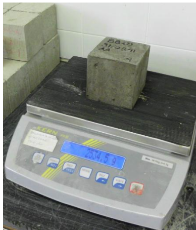
Figura 3.24 - Pesagem de provete cúbico
