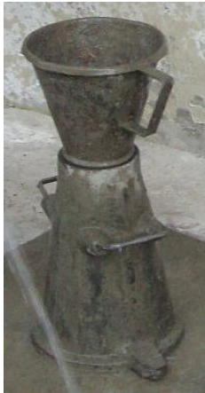
Figura 3.10 - Molde onde com duas pegas e duas abas junto à base
