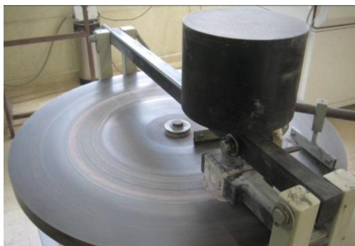
Figura 3.46 - Provete sujeito a desgaste com rotação em pleno ensaio
