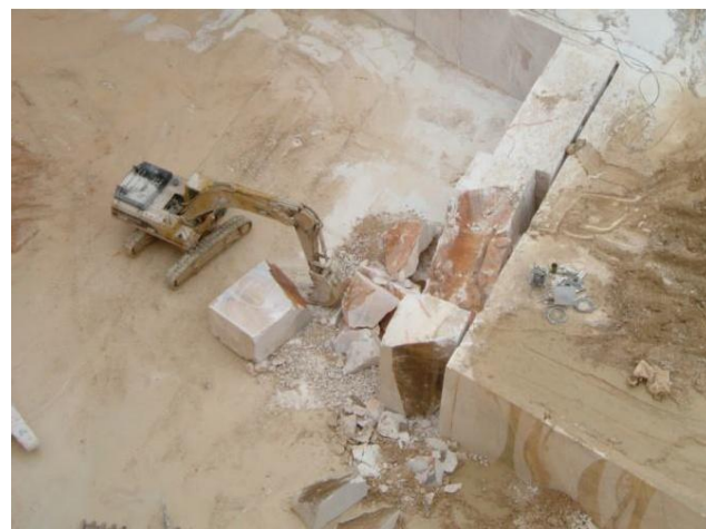
Figura 2.9 - Derrube com a escavadora giratória
