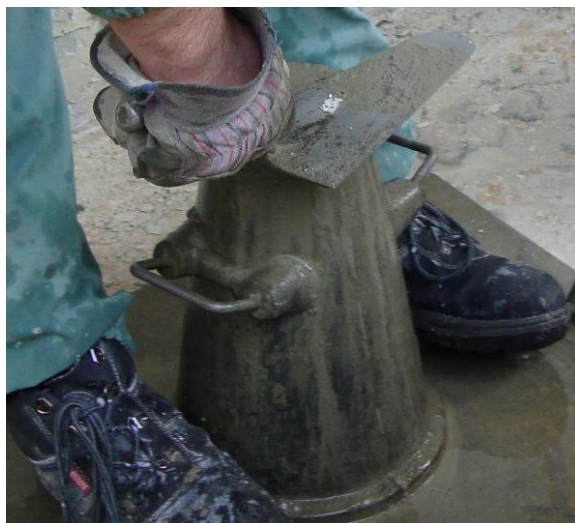
Figura 3.14 - Alisamento da superfície no topo do modo com o auxílio da colher de pedreiro
