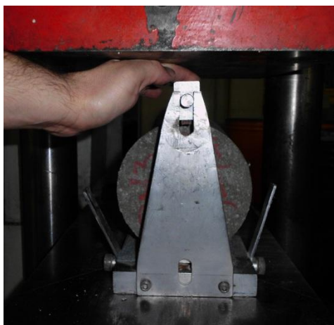
Figura 3.29 - Vista de topo de provete cilíndrico colocado no posicionador, com este centrado
