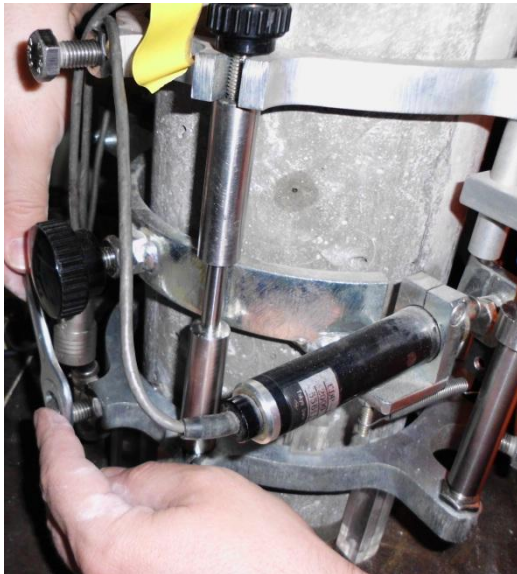
Figura 3.35 - Montagem do sistema de medição de deformações
