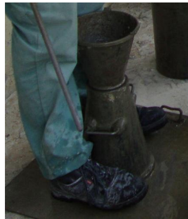
Figura 3.11 - Utilização dos pés do operador para fixação do molde à placa metálica
