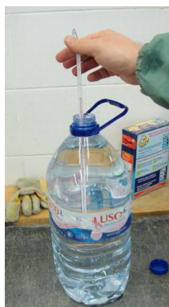
Figura 3.4 - Medição da temperatura da água no picnómetro
