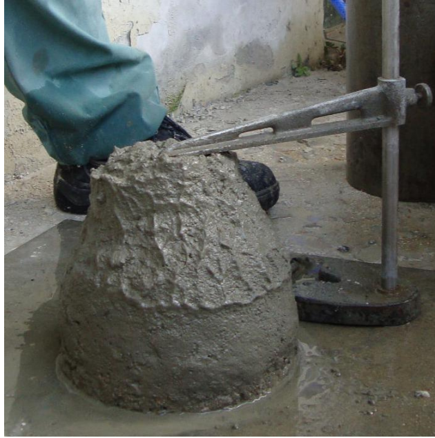
Figura 3.17 - Medição do abaixamento ( h )
