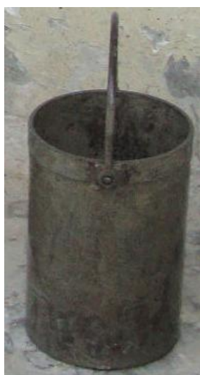
Figura 3.20 - Recipiente para medição da massa volúmica do betão no estado fresco
