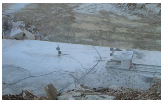
Figura 2.7 - Serragem de uma talhada com máquina de fio diamantado
