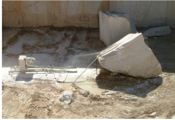
Figura 2.10 - Esquadreamento de um bloco
