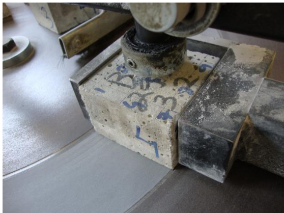
Figura 3.44 - Provete com face de desgaste voltada para baixo e marcações na face de topo
