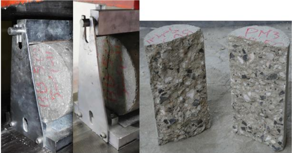
Figura 3.31 - Fases da rotura (as duas primeiras fotos correspondentes a betão com agregados grossos (100% basalto) e última a betão composto por agregados grossos de basalto e mármore (50%))
