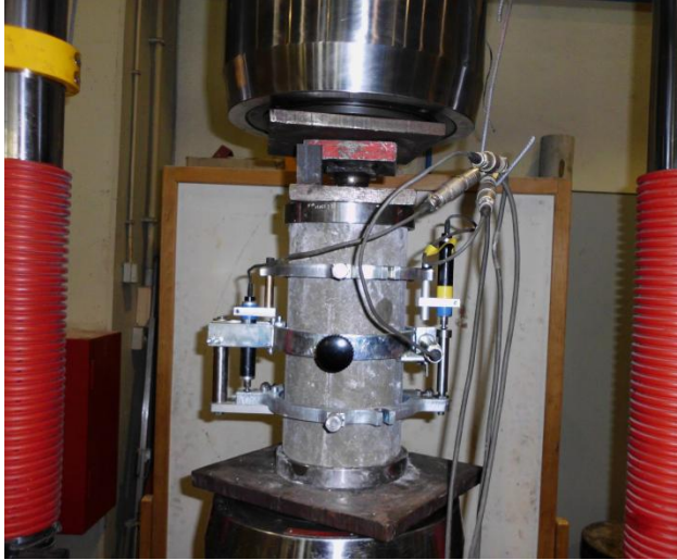
Figura 3.38 - Extensómetros colocados em posições diametralmente opostas
