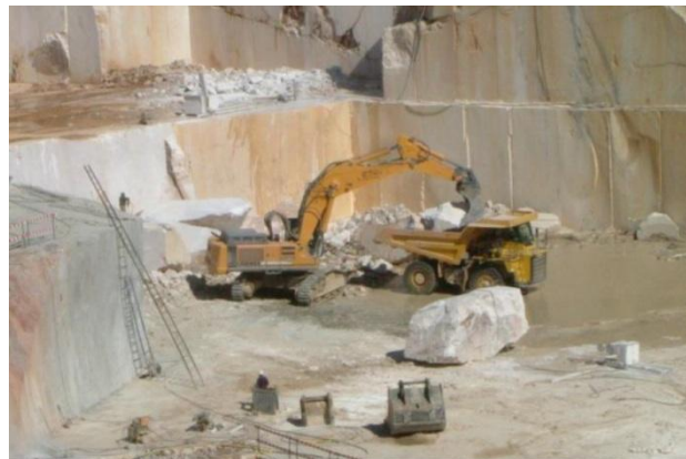
Figura 2.11 - Transporte de resíduos
