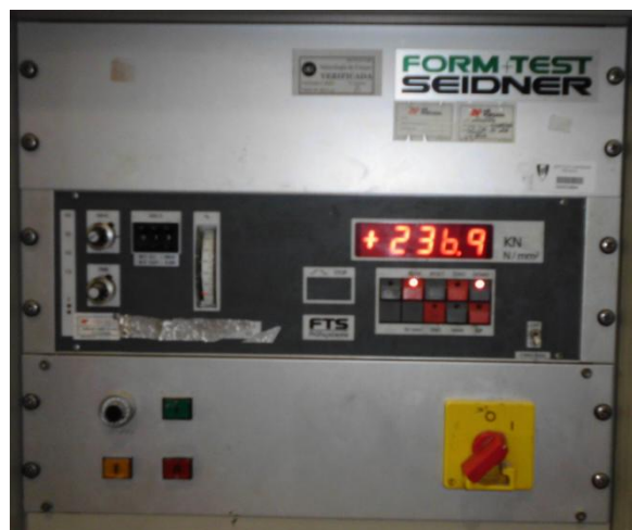
Figura 3.32 - Leitura de carga no mostrador do sistema acoplado à prensa hidráulica
