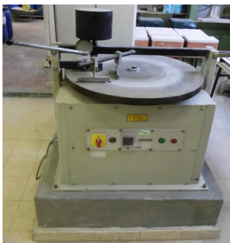
Figura 3.40 - Máquina de abrasão de Böhme
