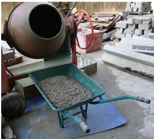
Figura 3.12 - Colocação da amostra no carro de mão após realização da amassadura
