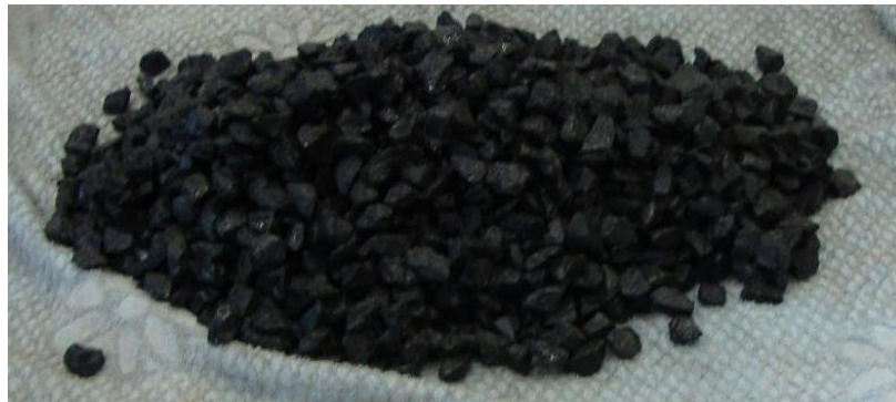
Figura 3.5 - Colocação de provete, de agregado grosso de basalto, sobre toalha para posterior secagem
