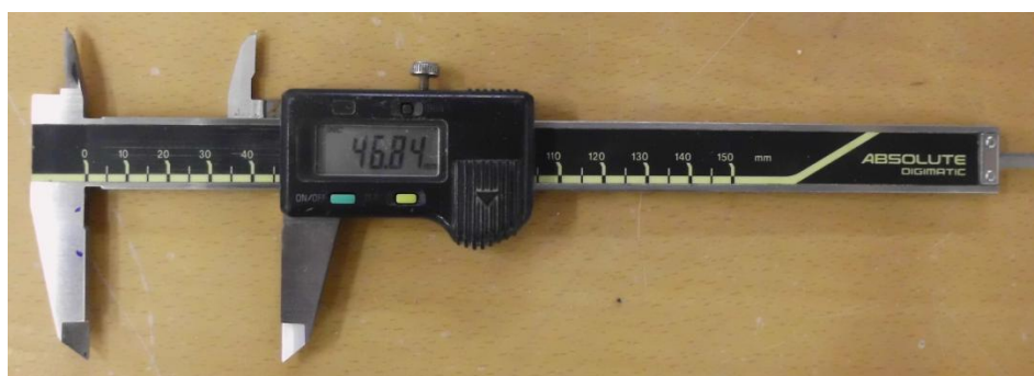
Figura 3.9 - Paquímetro utilizado na medição das dimensões das partículas
