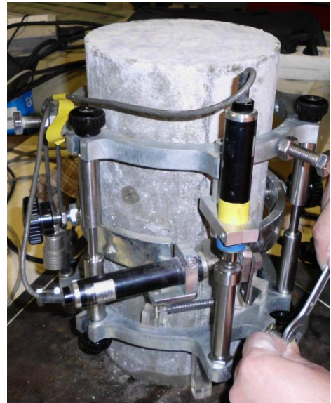
Figura 3.36 - Fixação dos anéis integrantes do sistema de medição de deformações
