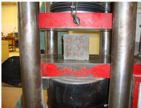
Figura 3.23 - Prensa hidráulica de 4 colunas
