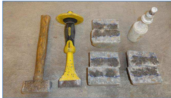
Figura 3.15 - Provetes partidos ao meio com aplicação de nitrato de prata
