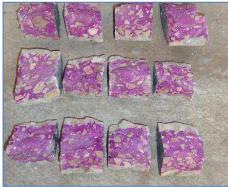
Figura 3.14 - Provetes de ensaio partidos em quartos de provete e após aplicação de fenolftaleína
