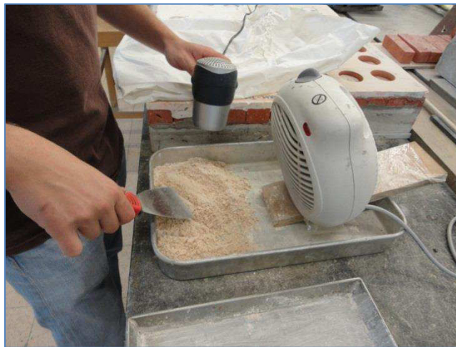
Figura 3.6 - Secagem do provete com uma corrente de ar quente
