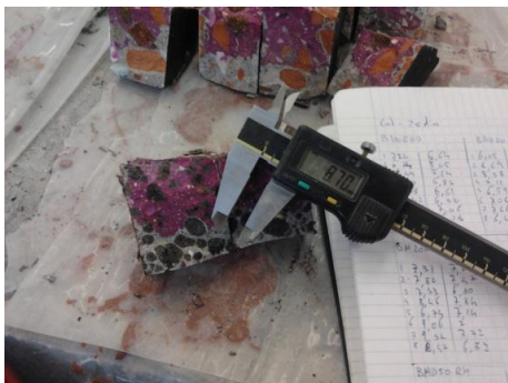
Figura 3.24 - Profundidade de carbonatação
