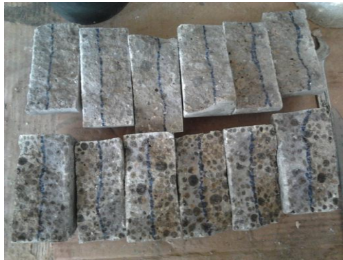
Figura 3.29 - Profundidade de penetração de iões cloreto
