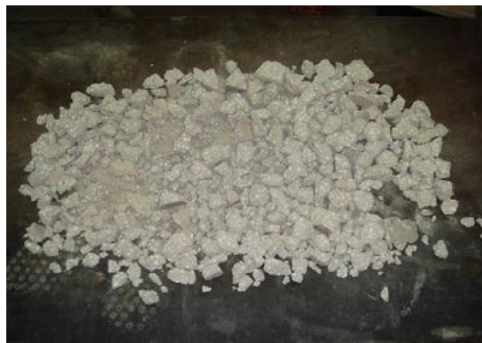
Figura 2.8 - Agregado reciclado de betão leve com vidro expandido (Kralj, 2009)
