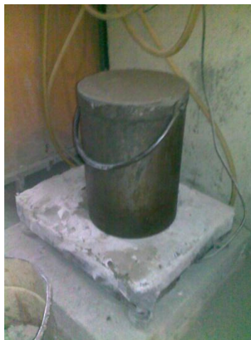
Figura 3.19 - Pesagem do betão no estado fresco
