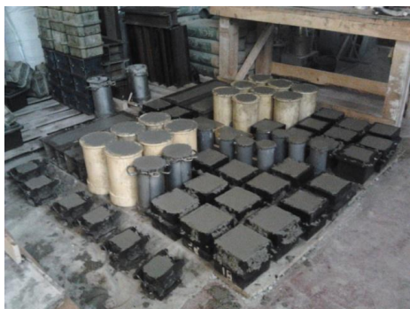
Figura 3.9 - Moldes após a colocação do betão
