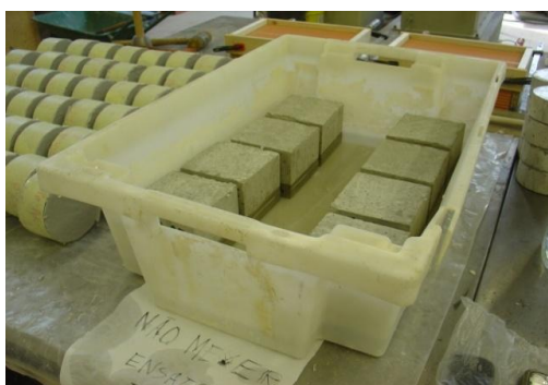
Figura 3.22 - Provetes imersos a 1/3 da sua altura
