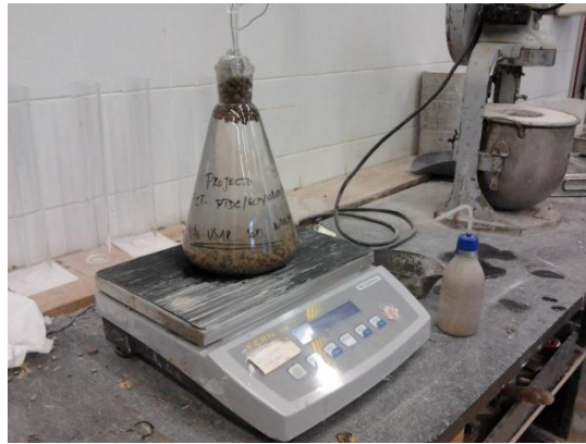
Figura 3.16 - Pesagem do conjunto agregado + picnómetro
