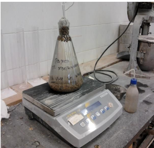
Figura 3.3 - Pesagem do picnómetro com amostra inserida
