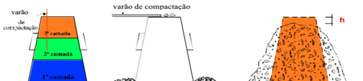
Figura 3. 24 - Ensaio de abaixamento
