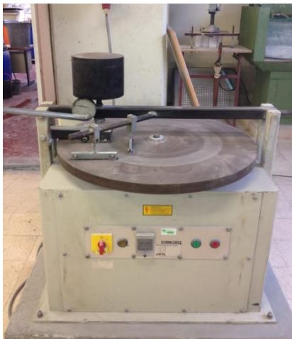
Figura 3.34 - Máquina de Böhme
