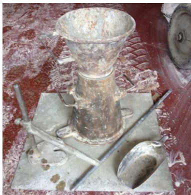
Figura 3. 23 - Placa, molde metálico de forma troncocónica, varão de compactação, colher de pedreiro, régua e funil
