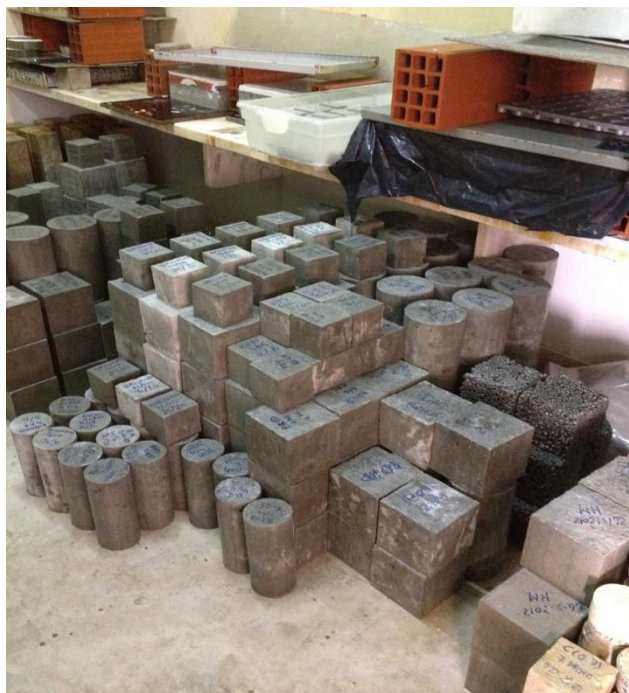
Figura 3. 22 - Camara húmida e respectivos provetes
