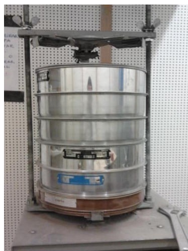
Figura 3.2 - Agitador de peneiros e peneiros da série 933-2
