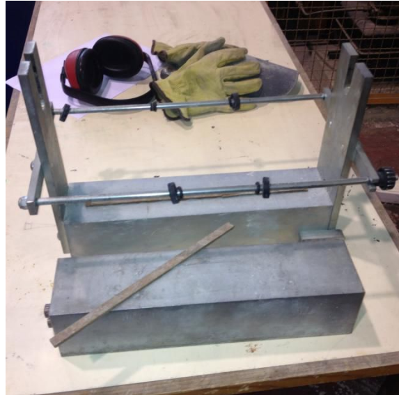
Figura 3. 31 - Posicionador, peça de carga em aço e faixas de cartão prensado
