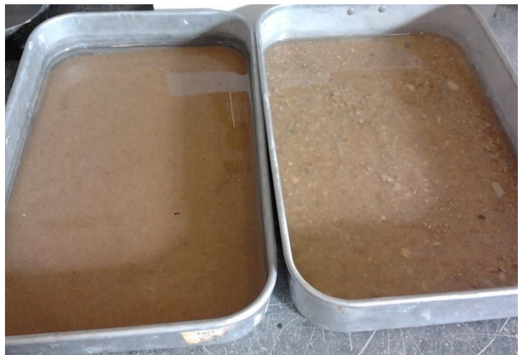
Figura 3.4 - Partículas de agregado de dimensão entre 0,063 e 4,0 mm retiradas do picnómetro
