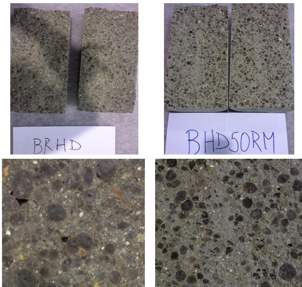
Figura 4. 35 - Superfície de ruptura das misturas da série BHD (ruptura pelo agregado em ambas as substituições por RLHD e RLM)
