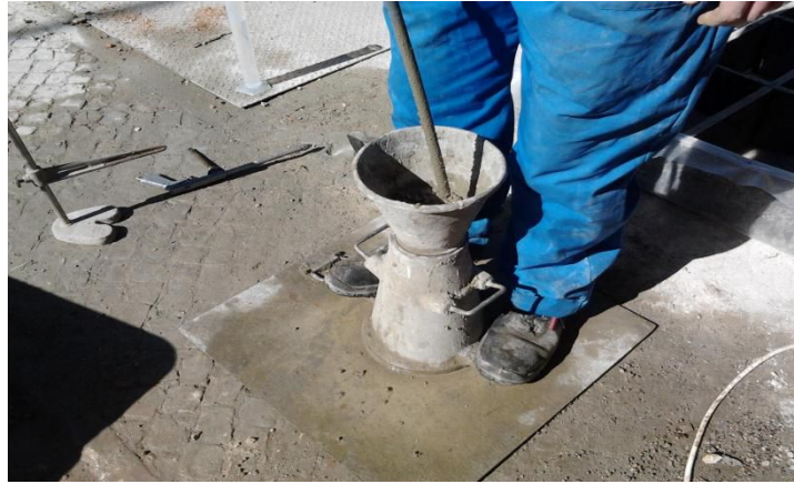
Figura 3. 25 - Ensaio de abaixamento
