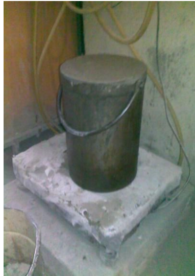
Figura 3. 28 - Ensaio da massa volúmica fresca
