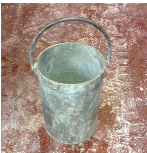
Figura 3. 27 - Recipiente estanque de 10l de capacidade
