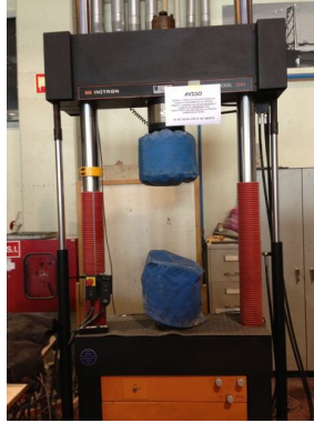
Figura 3.24 - Prensa hidráulica do ensaio de módulo de elasticidade
