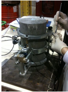
Figura 3.25 - Montagem do ensaio de módulo de elasticidade
