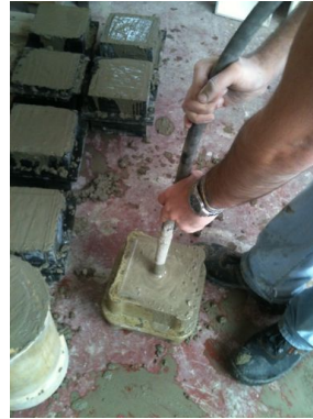
Figura 3.17 – Vibração do betão
