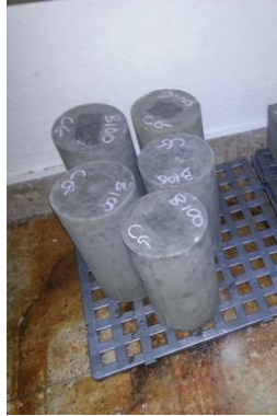
Figura 3.23 - Provetes de ensaio de resistência à tracção
