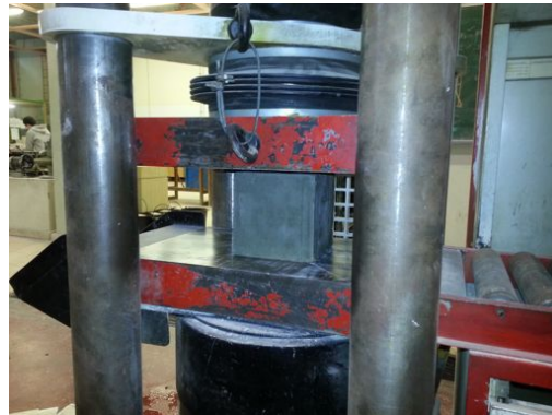
Figura 3.19 – Ensaio de resistência à compressão
