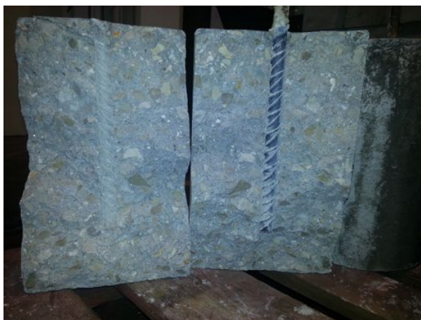
Figura 5.8 - Abertura de um plano de fendilhação
