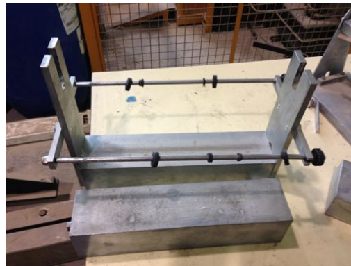
Figura 3.22 - Posicionador de provetes e peça de carga do ensaio de resistência à tracção por compressão diametral
