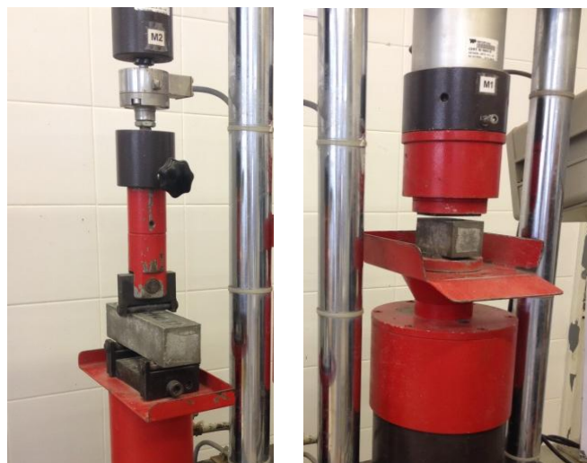
Figura 5.6 - Prensa hidráulica para ensaio de flexão (à esquerda) e compressão (à direita)
