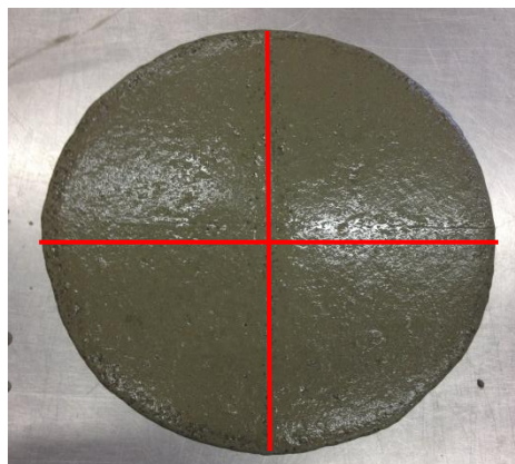
Figura 5.4 - Espalhamento da argamassa e diâmetros a medir
