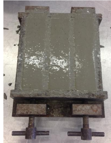
Figura 5.4 - Molde para produção de 3 provetes prismáticos de argamassa
