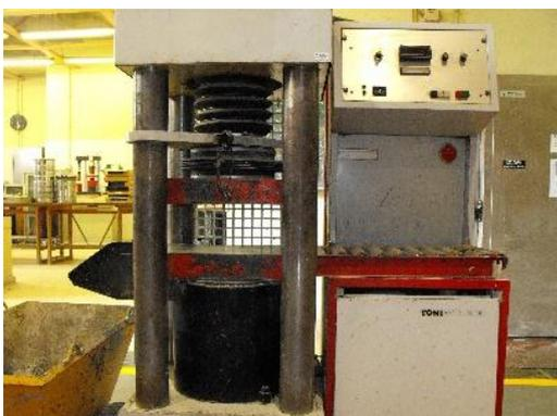
Figura 24 - Prensa hidráulica
