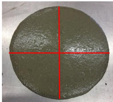
**Figura 7 - Espalhamento da argamassa e diâmetros a medir**
