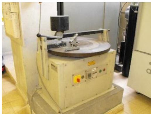
**Figura 30 - Máquina de abrasão de Böhme**
