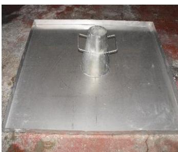
**Figura 12 - Cone de Abrams e chapa metálica**
