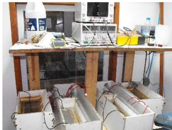
**Figura 41** - Fonte de alimentação (em cima) e reservatórios de plástico (em baixo)
