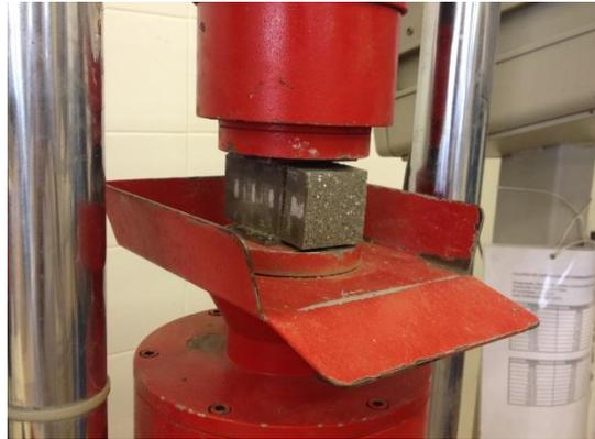
Figura 10 - Rotura do provete prismático à compressão
