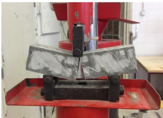
**Figura 9 - Rotura do provete prismático à flexão**
