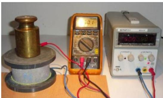
**Figura 38 - Da esquerda para a direita: peso de 2 kg, placas de cobre, amperímetro e fonte de alimentação (Silva, 2013)**
