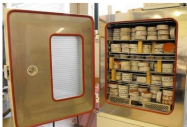
**Figura 43 - Câmara de carbonatação**
