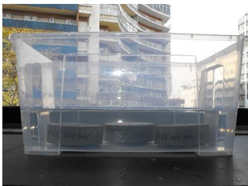
**Figura 37 - Ensaio de absorção de água por imersão**
