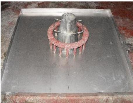
**Figura 21 - Anel J de 16 varões, cone de Abrams e chapa metálica**
