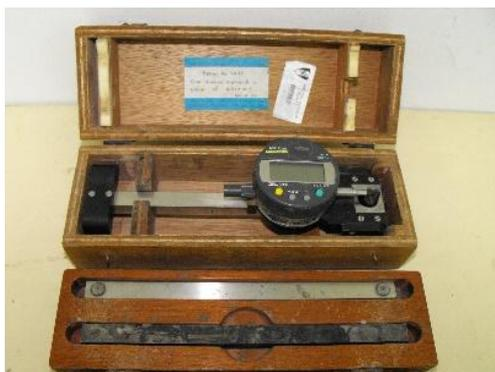
**Figura 31 - Aparelho de medição de extensões, barra calibradora e barra padrão**
