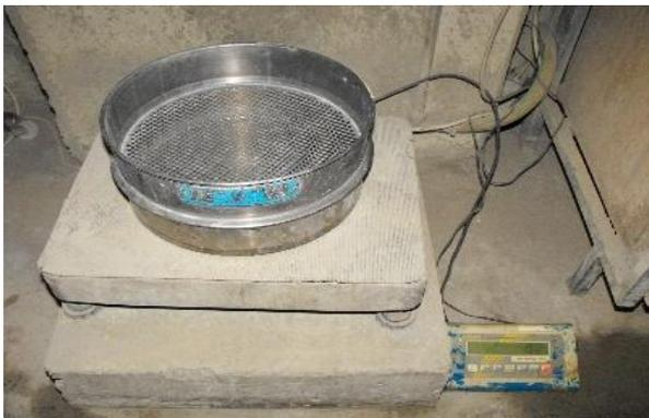
Figura 19 - Peneiro de 5 mm com fundo e balança
