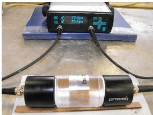
**Figura 23 - Equipamento de ultra-sons (calibração do equipamento)**
