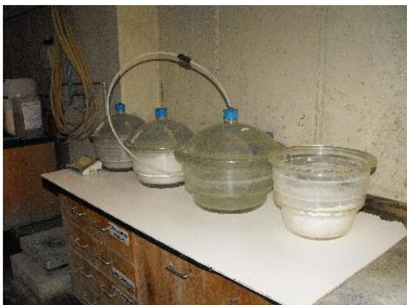
**Figura 40** - Exsiccador e bomba de vácuo
