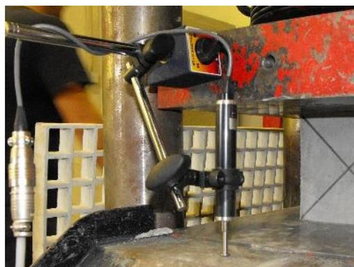
Figura 25 - Deflectómetro acoplado à prensa
