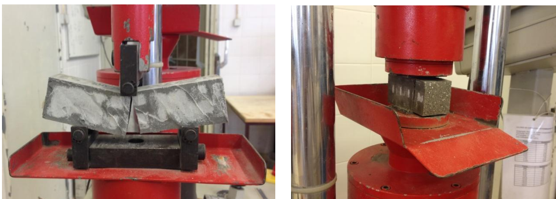
Figura 38 - Rotura do provete prismático à flexão (à esquerda) e à compressão (à direita)
