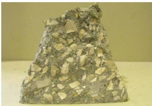
Figura 43 - Rotura apresentada pelo BAC com 10% SF e 400 kg/m 3 de cimento
