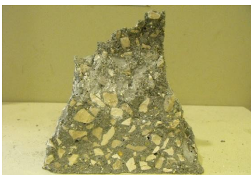
Figura 45 - Rotura apresentada pelo BAC com 15% SF e 400 kg/m 3 de cimento
