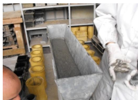
Figura 25 - Funil V completo de BAC e início da contagem do tempo
