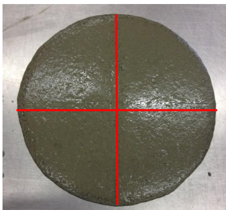
Figura 11 - Espalhamento da argamassa e diâmetros a medir
