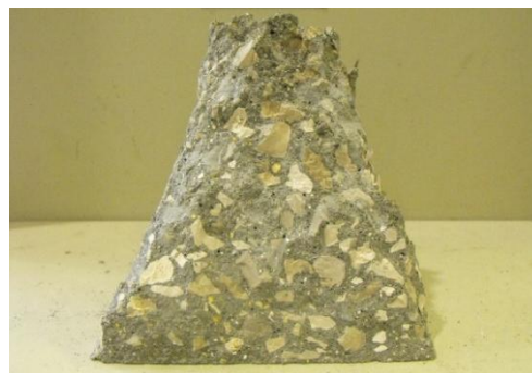
Figura 44 - Rotura apresentada pelo BAC com 10% SF e 450 kg/m 3 de cimento
