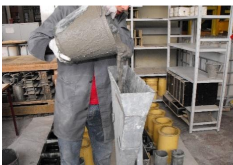
Figura 24 - Introdução do BAC no interior do funil V
