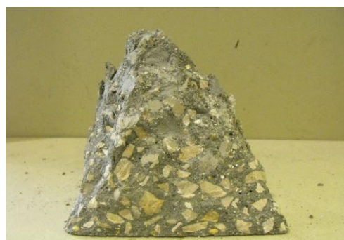
Figura 46 - Rotura apresentada pelo BAC com 15% SF e 450 kg/m 3 de cimento
