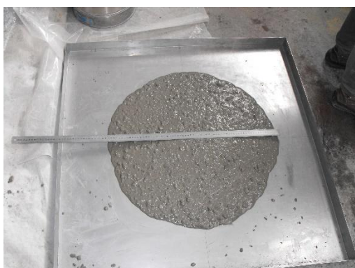
Figura 40 - Aspecto final do BAC no ensaio de espalhamento
