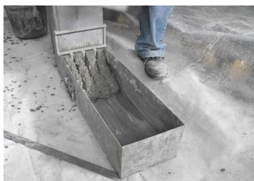
Figura 29 - Abertura da comporta da caixa L
