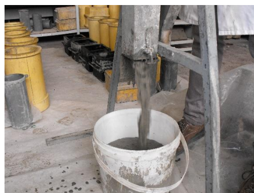
Figura 41 - Escoamento do BAC através do funil V
