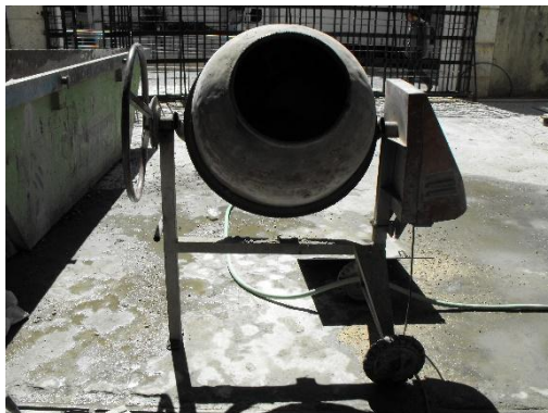
Figura 14 - Betoneira utilizada para as amassaduras de BAC
