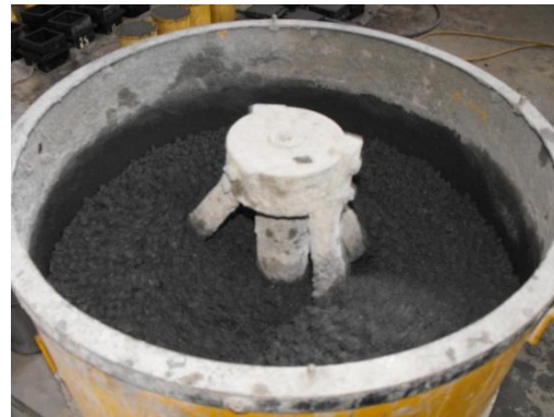
Figura 2 - Mistura com agregados finos, agregados grossos, sílica de fumo e 75% da água
