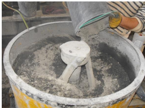
Figura 3 - Introdução de cimento na mistura
